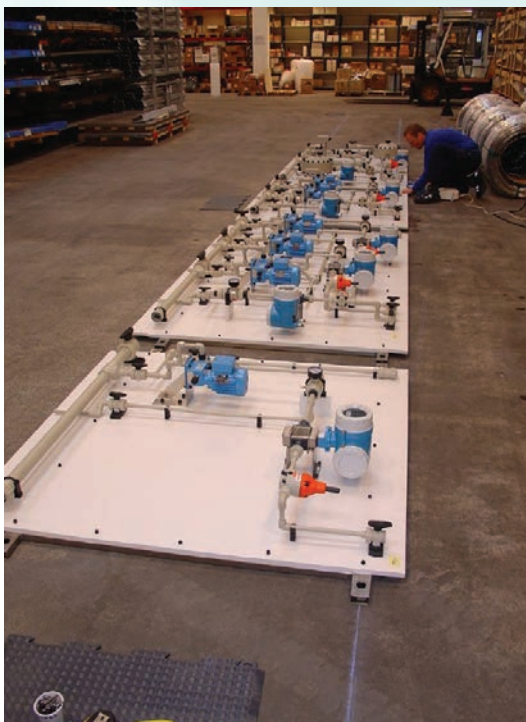
Opbygning af doseringsanlæg
