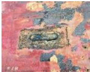
Anode before service 维修更换前的阳极
